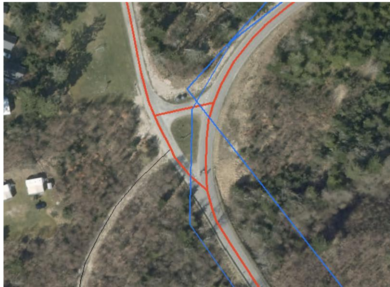
Figur 12. De indlagte blå ruter følger ikke de røde sti- og vejmidter fra GeoDanmark Grunddata. Sørg for at indlægge ruter via snap til GeoDanmark vej- og stimidter.
